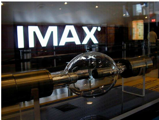
(ภาพที่ 4.8) หลอดขึ้นอน ขนาด 15 กิโลวัตต์ ที่ใช้กับ เครื่องฉายภาพยนตร์ ไอแมกซ์ (Image MAXimum)
