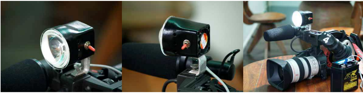
(ภาพที่ 4.21-2) ไฟหัวกล้อง ชนิดสร้างเอง ภาพจาก: www.manusmedia.com
